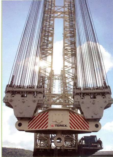
Der weltweit größte mit Last verfahrenbare Gittermast-Raupenkran Terex® Demag CC8800-I TWIN. Bild: DLoG GmbH
